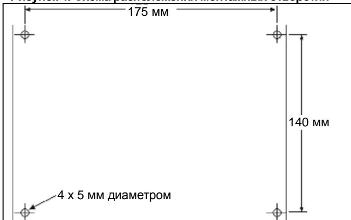
Рисунок 4: Схема расположения монтажных отверстий
