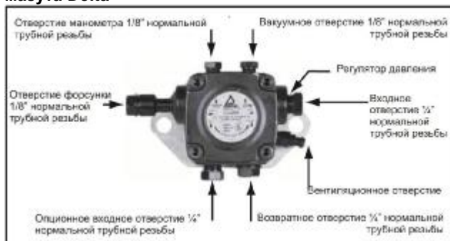
РИСУНОК 36: Детализированный чертеж двухступенчатого насоса Suntlet
